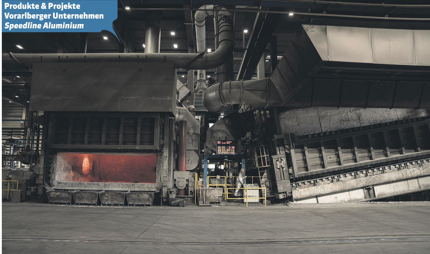
In Schlins werden recycelte Aluminiumschrotte wie Produktionsreste und Fahrzeugprofile in großen Schmelzöfen bei circa 700 °C eingeschmolzen.
