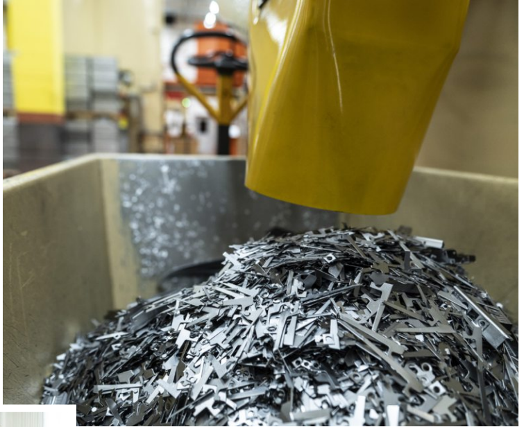
Der Stahlschrott, der in der Produktion anfällt, wird nach dem Multirecycling-Ansatz gesammelt und sortiert.
