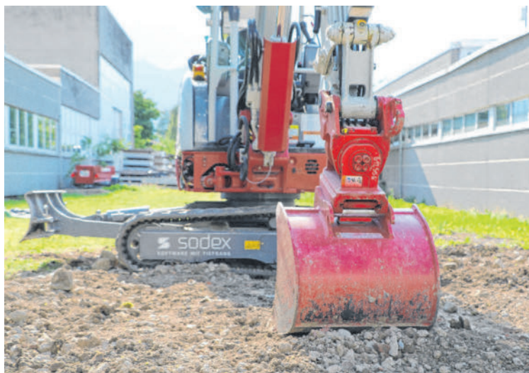
Durch die Aufrüstung mit einem Sodex-System können Bagger selbstständig arbeiten sowie Bauprozesse vereinfacht und automatisiert werden. SODEX INNOVATIONS
