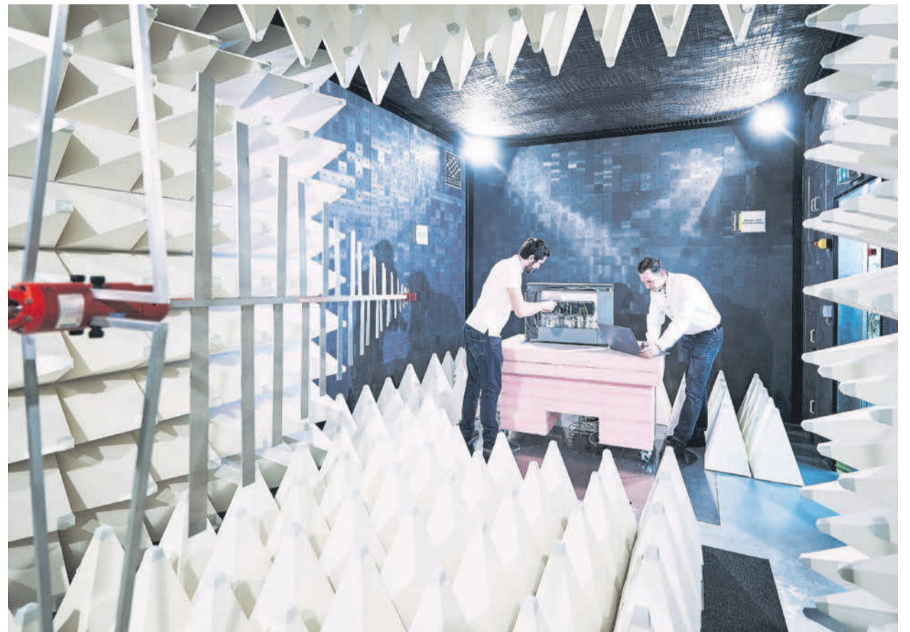
EMV-Untersuchungen bestimmen die elektromagnetische Verträglichkeit eines elektronischen Produkts. Das eigene EMV-Labor von Bachmann electronic kann auch von anderen Unternehmen für Prüfzwecke genutzt werden.
