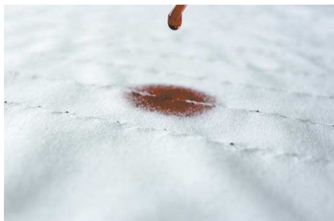
In die Wäsche eingestickte Edeltstahlgarne funktionieren als Feuchte-sensor und signalisieren per Funk.
